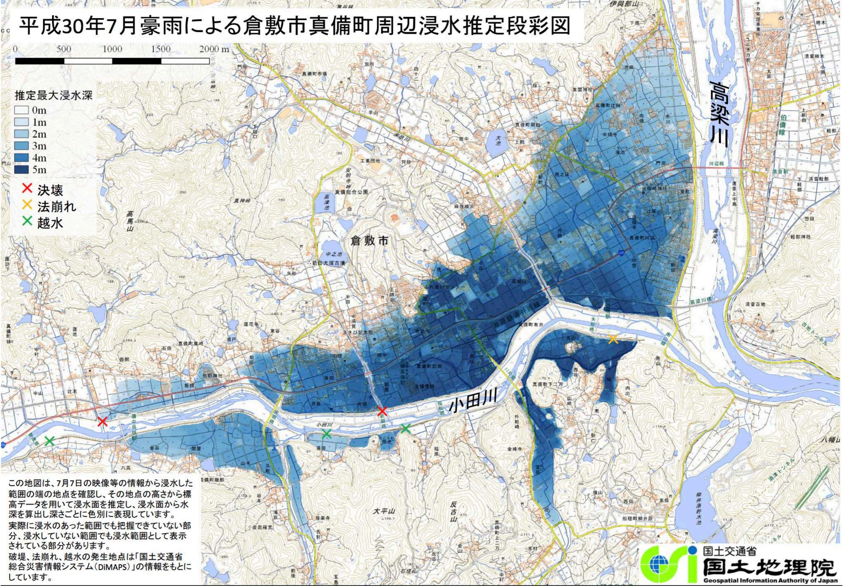
この地図は、7月7日の映像等の情報から浸水した範囲の端の地点を確認し、その地点の高さから標高データを用いて浸水面を推定し、浸水面から水深を算出し深さごとに色別に表現しています。実際に浸水のあった範囲でも把握できていない部分、浸水していない範囲でも浸水範囲として表示されている部分があります。破堤、法崩れ、越水の発生地点は「国土交通省総合災害情報システム(DiMAPS)」の情報をもとにしています。
